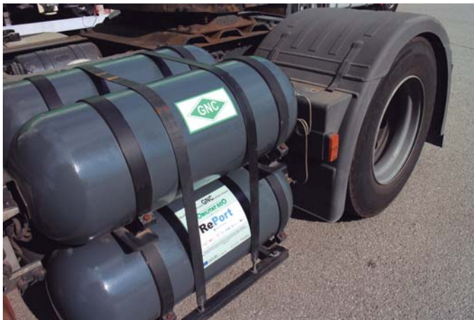
Depósitos de gas instalados en uno de los camiones del proyecto. Foto EG.
