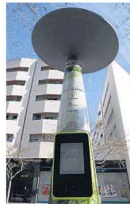
ESTACIÓN DE MOBEPOINT DE RECARGA DE MOTOS ELÉCTRICAS
