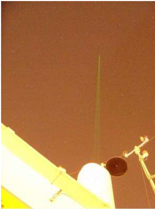
Micropulse Lidar instalado en el Observatorio de Santa Cruz (SCO) del Observatorio Atmosférico de Izaña, midiendo durante la noche. El haz verde es emitido por un láser en 523 nm.
