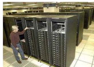
Casi 16.000 procesadores Cell, diseñados originariamente para ser el 'alma' de la PlayStation 3, trabajan en paralelo para convertir a 'Roadrunner' ('Correcaminos', en inglés) de IBM en el supercomputador más rápido del mundo.
