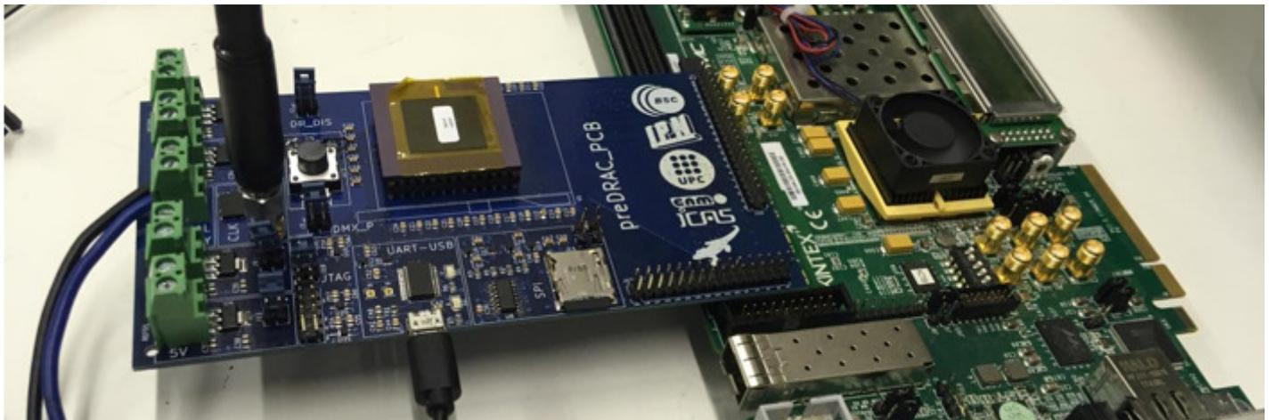
Lagarto, construido con transistores TSMC de 65 nanómetros, es el primer chip con repertorio de instrucciones (ISA, Instruction Set Architecture) de código abierto desarrollado en España, coordinado por el Barcelona Supercomputing Center - Centro Nacional de Supercomputación. El chip, que ha dado unos resultados superiores a los esperados, es un paso clave en la estrategia del centro de convertirse en referente en las tecnologías de hardware de código abierto desarrolladas en Europa.
